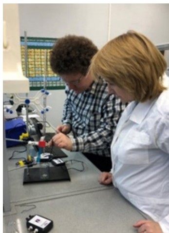
Рисунок 1. Процесс калибровки датчика водородного показателя
